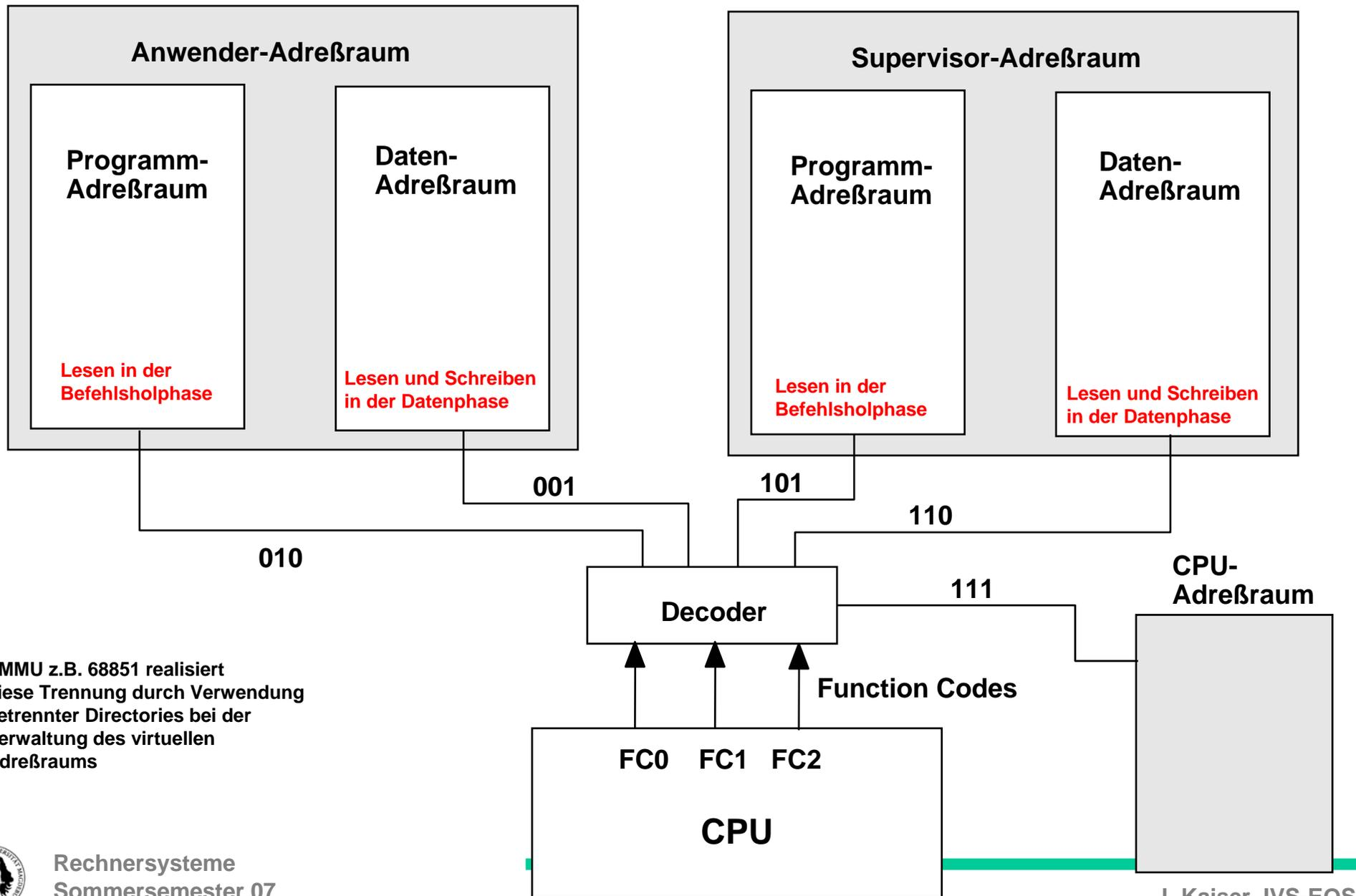
PMMU z.B. 68851 realisiert diese Trennung durch Verwendung getrennter Directories bei der Verwaltung des virtuellen Adreßraums
