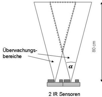
In Vereinfachung zu den im Datenblatt gemachten Aussagen, kann, wie in der Abbildung dargestellt von einem konstanten, bezogen auf die Sensorachse symmetrischen Öffnungswinkel von  $\alpha = 16^\circ$  ausgegangen werden.
