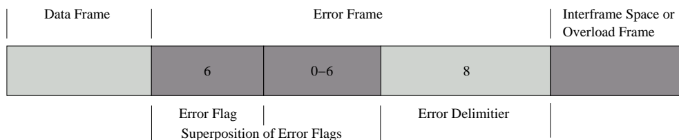
Abbildung 2.3: CAN-Fehlernachricht nach [Rob91]
